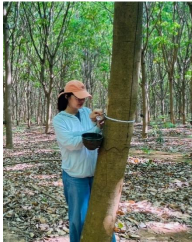
ภาพที่ 1.10 การวัดขนาดเส้นผ่านศูนย์กลางเพียงอก (DBH) ที่ระดับความสูง 1.30 เมตรเหนือพื้นดิน
