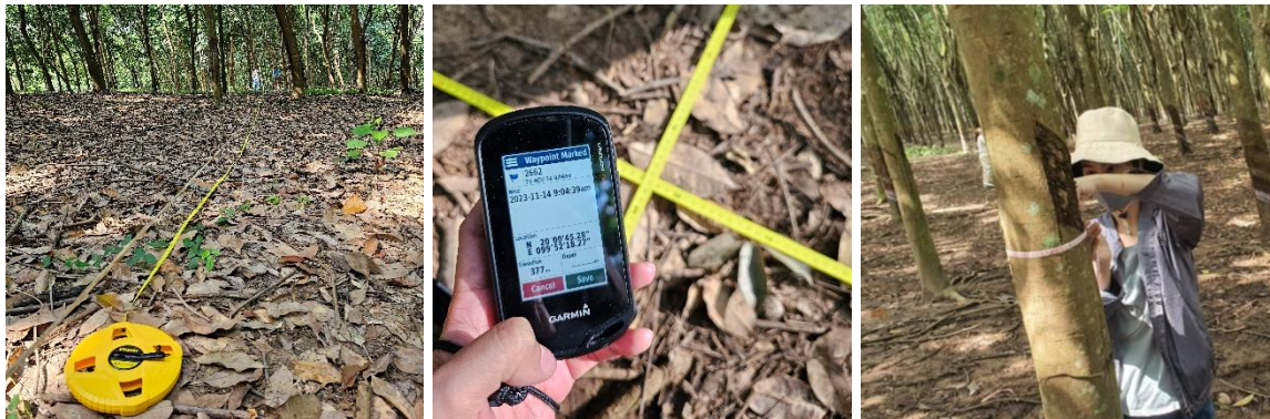
ภาพที่ 18 เครื่องมือเก็บข้อมูลต้นไม้ (เทปวัดระยะ เครื่องบันทึกพิกัด GPS และสายวัด)
