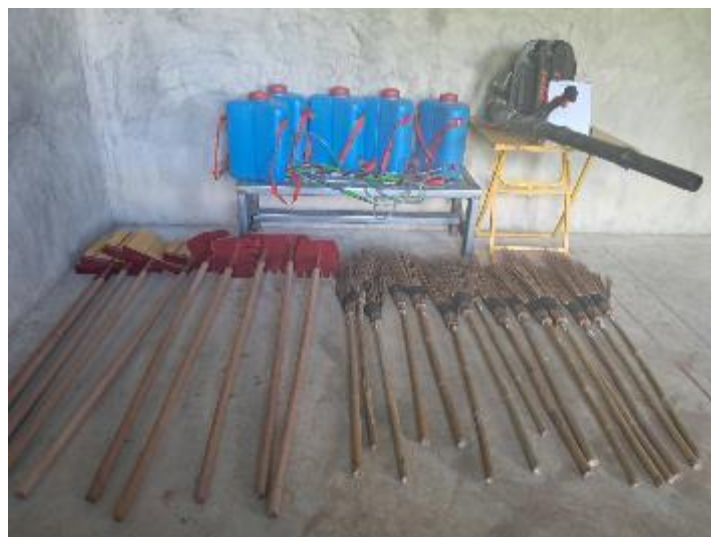
ภาพที่ 9 วัสดุและอุปกรณ์ดับไฟป่า
