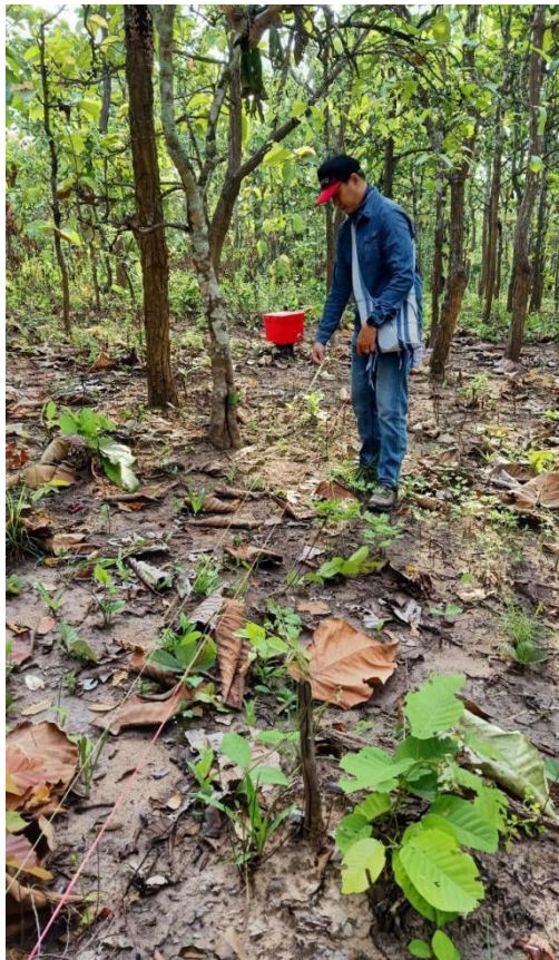
ภาพที่ 36 การแบ่งระยะทุก 10 เมตร แล้วตอกเหล็กเส้นพร้อมกัน
