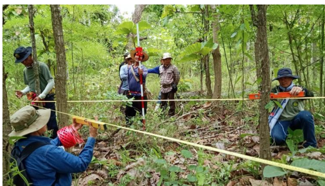
ภาพที่ 35 การกำหนดแนวหลัก ( Base line)
