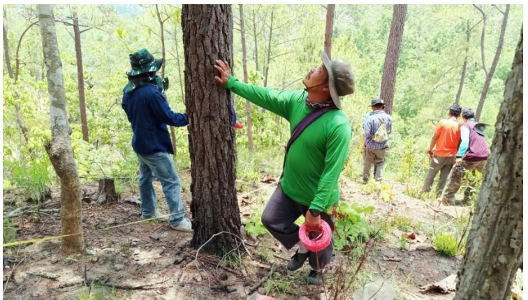
ภาพที่ 36 การแบ่งระยะทุก 10 เมตร แล้วตอกเหล็กเส้นพร้อมกัน
