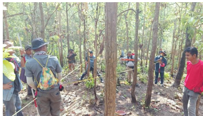
ภาพที่ 35 การกำหนดแนวหลัก ( Base line)
