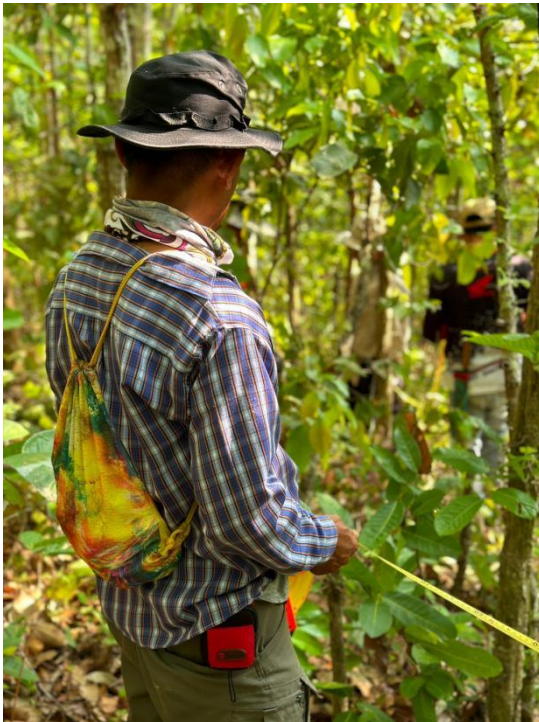
ภาพที่ 40 การวัดระยะ X,Y เพื่อหาตำแหน่งของต้นไม้แต่ละต้นในแปลงตัวอย่าง
