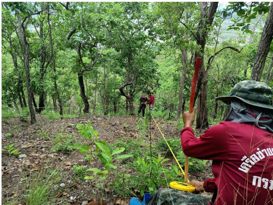
ภาพที่ 224 เทปวัดกำหนดแนวหลัก (Base Line) ของแปลงตัวอย่าง
