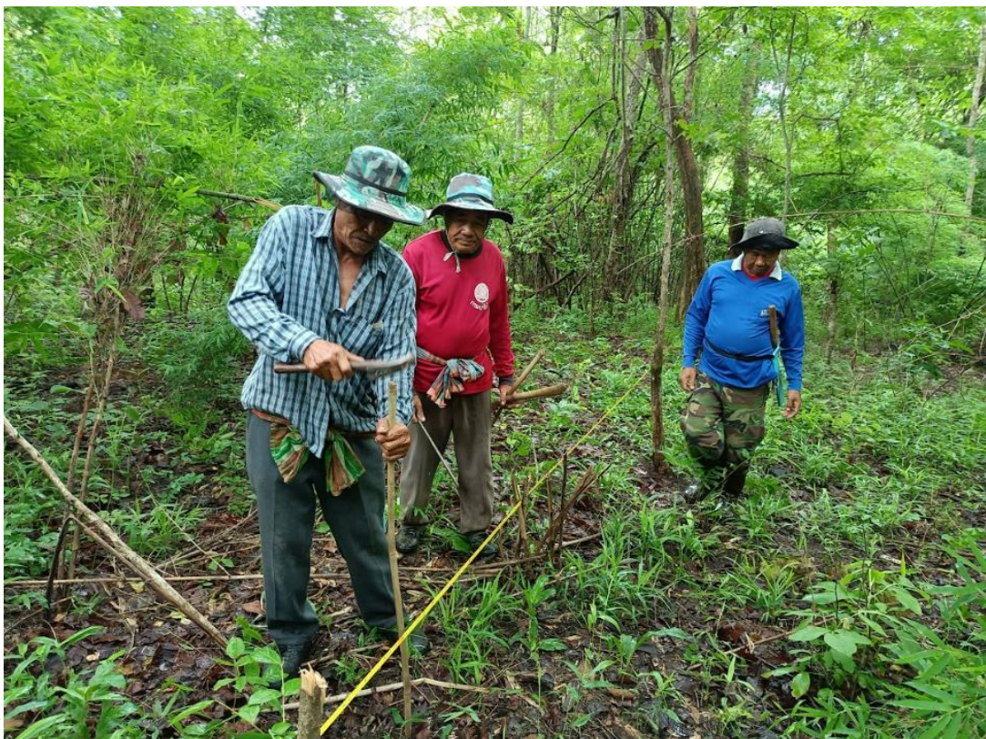
ภาพที่ 225 การดึงเทปจากแนวหลักเพื่อทำแปลงขนาด 10 เมตร x 10 เมตร
