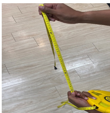
ภาพที่ 2 การสอบเทียบอุปกรณ์และตรวจสอบความสมบูรณ์ของอุปกรณ์เทปวัดระยะ ยี่ห้อ Stanley รุ่น Fiberglass Long Tape Rule 34-260
