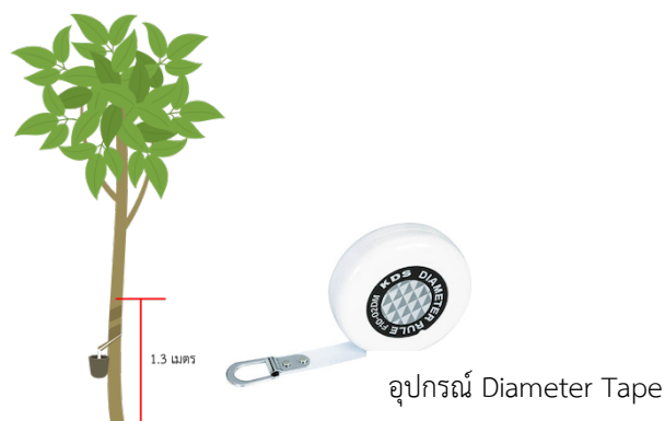
ภาพที่ 8 การวัดขนาดเส้นผ่านศูนย์กลางเพียงอก (DBH) ที่ระดับความสูง 1.30 เมตรเหนือพื้นดิน และอุปกรณ์ที่ใช้วัด DBH
