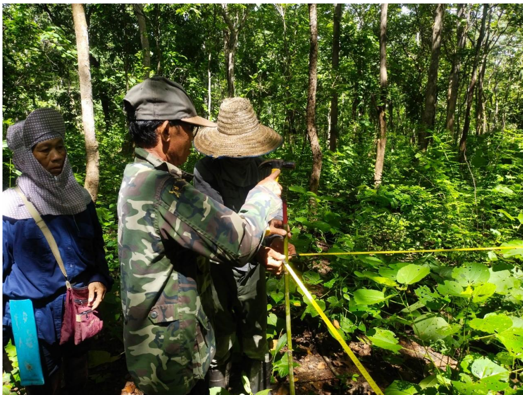
ภาพที่ 122 เทปวัดกำหนดแนวหลัก (Base Line) ของแปลงตัวอย่าง
