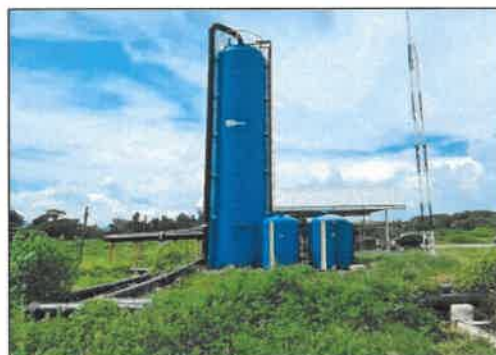
ระบบปรับปรุงคุณภาพก๊าซชีวภาพ (H 2 S Bio-Scrubber)
